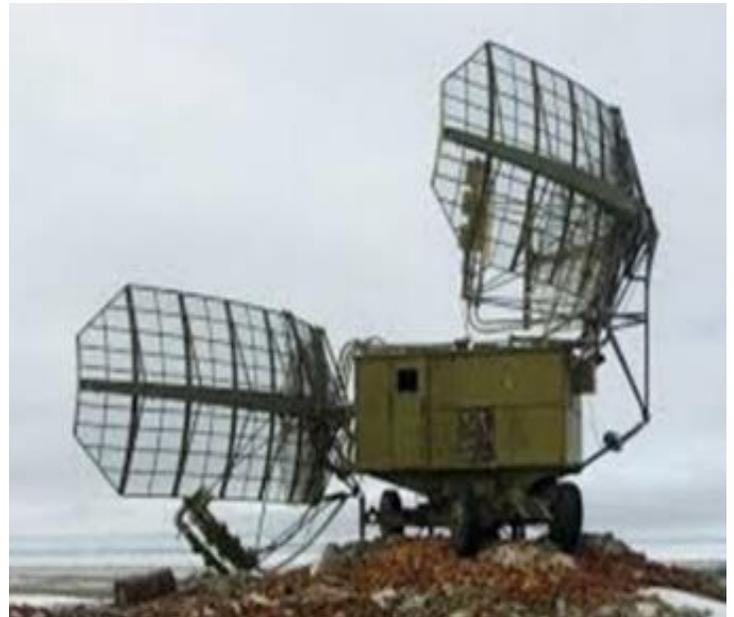
[Figure 3 - Bar Lock Radar](#)
